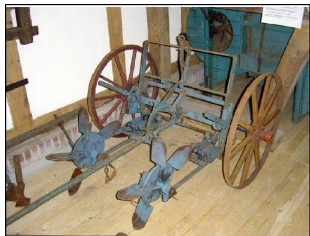
Kartoffelpflanzlochmaschine, wie sie der Verein seinen Mitgliedern zur Verfügung stellte
