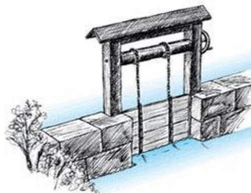
Ein Wehr oder auch Kropfschwelle, die den Wasserdurchlass regelt (WWA Ansbach)
